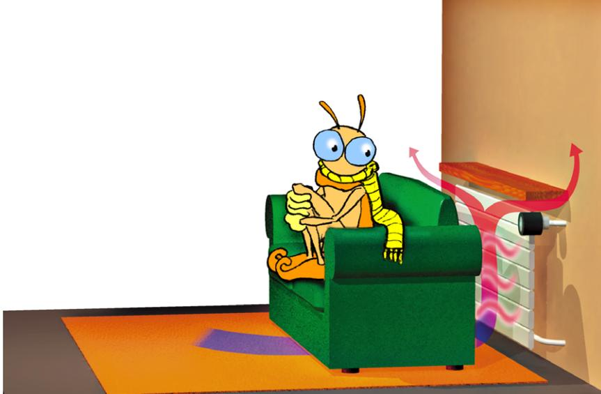
**Zugestellt kann der Heizkörper nicht richtig funktionieren.** Die Sofalehne unterbricht die Wärmeabstrahlung – so kann die Strahlungswärme die Personen nicht direkt erreichen. Ausserdem hindern Fenstersims und Sofa die Luft daran, frei um den Radiator zu zirkulieren.
